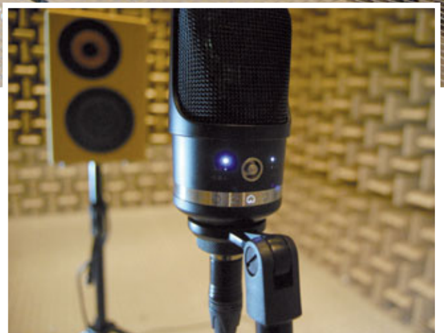
Abb. 1: Die gewählten Einstellungen werden beim Anliegen der 48 Volt Phantomspannung beleuchtet hervorgehoben – nach etwa 10 Sekunden schalten sich die LEDs automatisch ab, sofern in dieser Zeit keine weiteren Eingaben erfolgt sind
