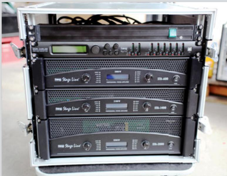
IMG Stage Line Amprack mit drei Endstufen aus der STA-Serie und dem DSM-260 LAN Controller (rechts: Doppel-15-Zoller mit 12-Zoll-Topteil aus der „Mega“-Serie)
