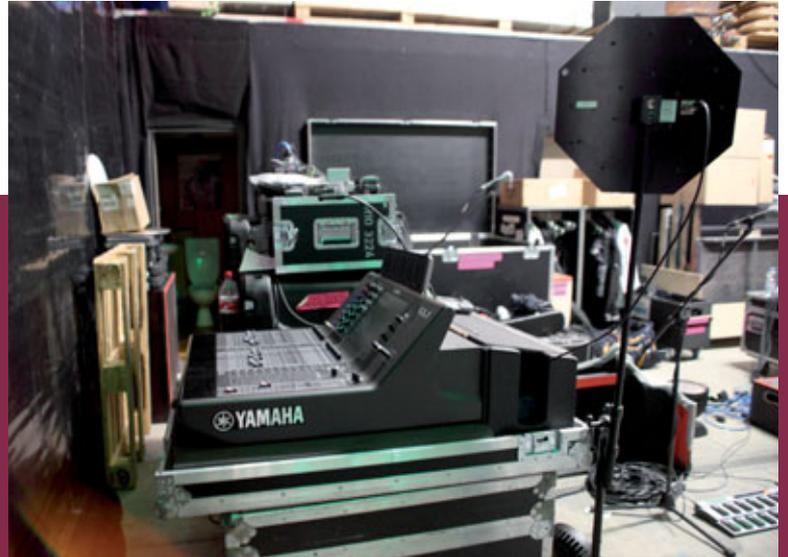
Entspannte Ruhe bei der Vorproduktion – im Hintergrund das Rack für die Yamaha CL-1, davor das Pult und im Vordergrund eine Richtantenne für die IEM-Systeme
