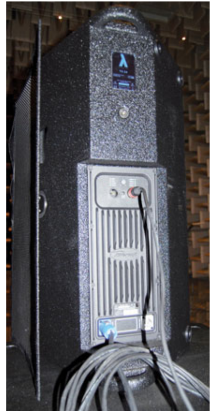
Abb 3: Rückansicht der TX-3A mit Endstufenmodul von Powersoft; per Druckschalter können vier verschiedene Presets ausgewählt werden
