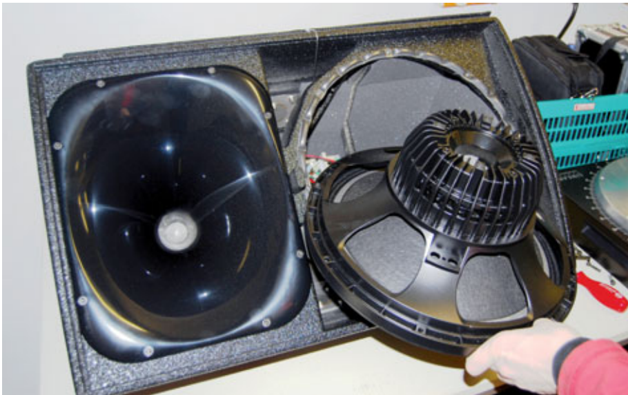
Abb 5: Hochwertige Bestückung mit großem Hochtonhorn von 18sound (Treiberbestückung von BMS) sowie sehr kräftigem 15-Zoll-Tieftöner mit 4-Zoll-Schwingspule, ebenfalls von 18sound
