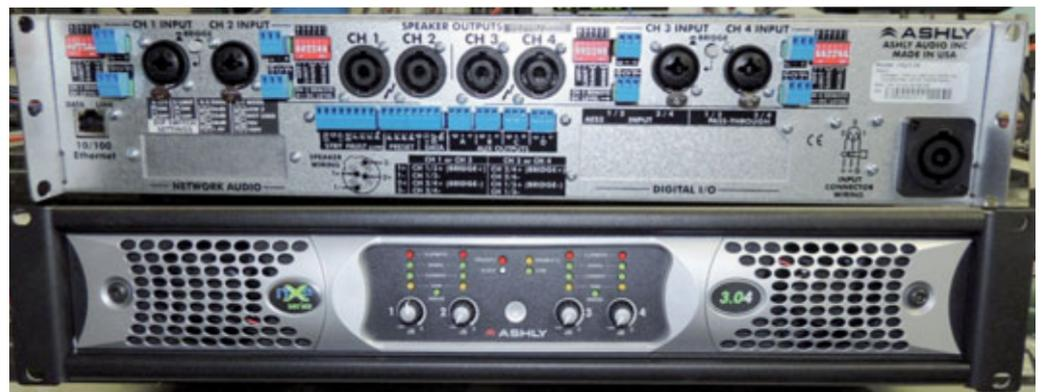
Bild 2: Die Ashly nXp 3.04 in der Vorder- und Rückansicht: XLR- und Speakon-Buchsen sowie die DIP-Schalter „stehen auf dem Kopf“; Grund sind die umgekehrt eingebauten Platinen im Gehäuse der Endstufe
