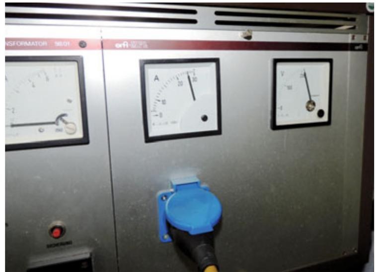
Bild 9: Die Stromversorgung im tool-labor ist für 32 Ampere ausgelegt; bei den Messungen mit 60-Hz-Burst-Signalen in Bild 8 genehmigt sich die Endstufe kurzzeitige Stromimpulse bis über 25 Ampere
