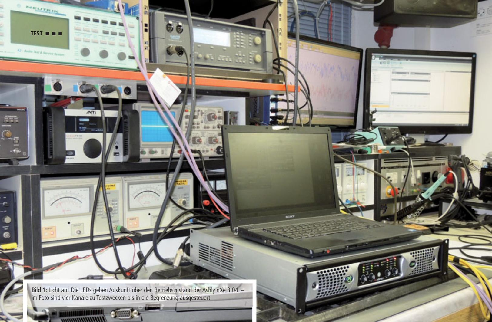
Bild 1: Licht an! Die LEDs geben Auskunft über den Betriebszustand der Ashly nXe 3.04. – im Foto sind vier Kanäle zu Testzwecken bis in die Begrenzung angesteuert
