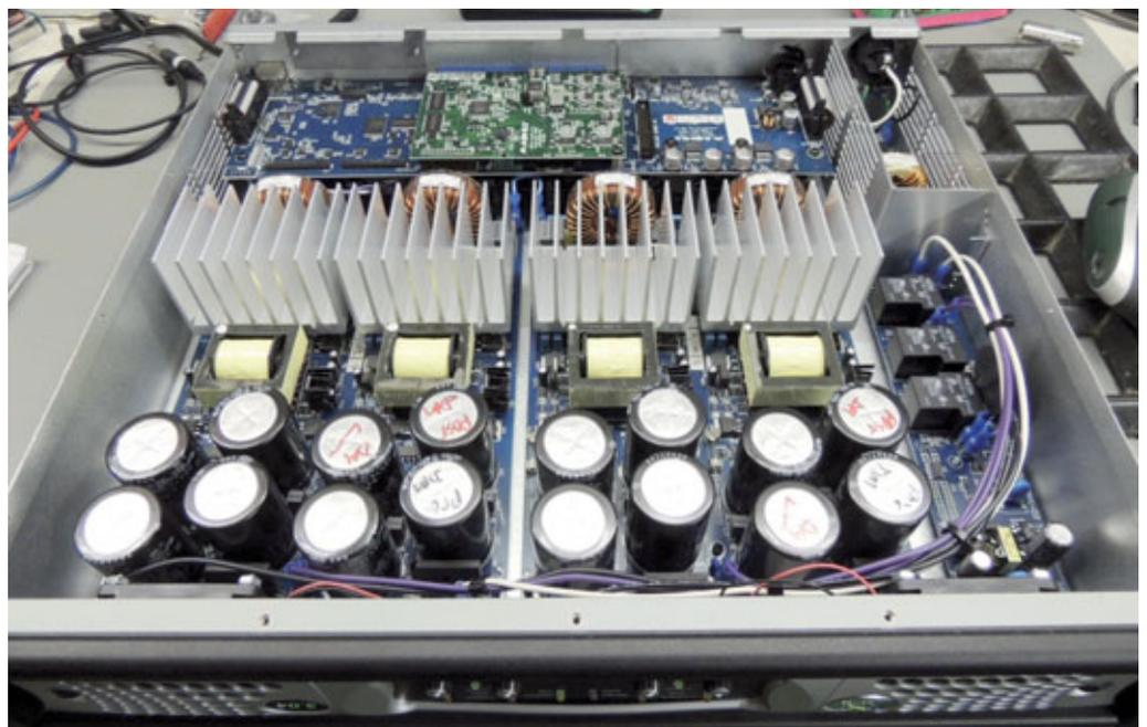
Bild 3: Zwei Stereoendstufenplatinen mit integrierten Netzteilen sind im Gehäuse der Ashly nXp 3.04 untergebracht; hinten ist die DSP-Platine und das Endstufen-Management zu sehen, rechts die Netzspannungsverteilung
