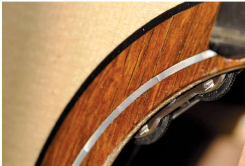
Die unauffällige Steuereinheit des AER AK-15 plus (Lautstärke und Mikrofonanteil) wird am Schalloch montiert; Schallwandler und Preamps sind in die Endpin-Buchse integriert
