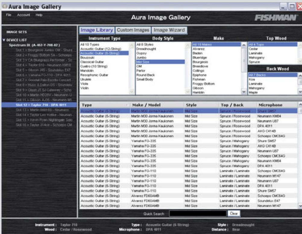
Die Image-Gallery-Software des „Aura“ Spectrum-Pedals hilft, die zahlreichen Images unterschiedlichster Gitarrentypen und Aufnahme-Setups zu organisieren und die Hardware mit den geeigneten Presets zu bestücken; in der Bluegrass-Sektion gibt es sogar Geigen und Bratschen-Images, falls der Gitarrist auch mal zur „Fiddle“ greift
