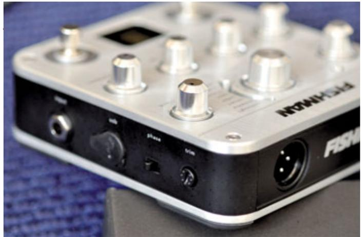
Das „Spectrum“-Pedal von Fishman bietet einen symmetrischen DI-Ausgang, um das Signal störgeräuschfrei an den FoH-Platz zu senden
