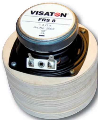
**Abb. 2:** Druckkammer in der Rückansicht; rechts daneben zwei Adapter-scheiben aus dem Zubehör eines Pistonfons (mechanischer Schallpegelkalibrator)
