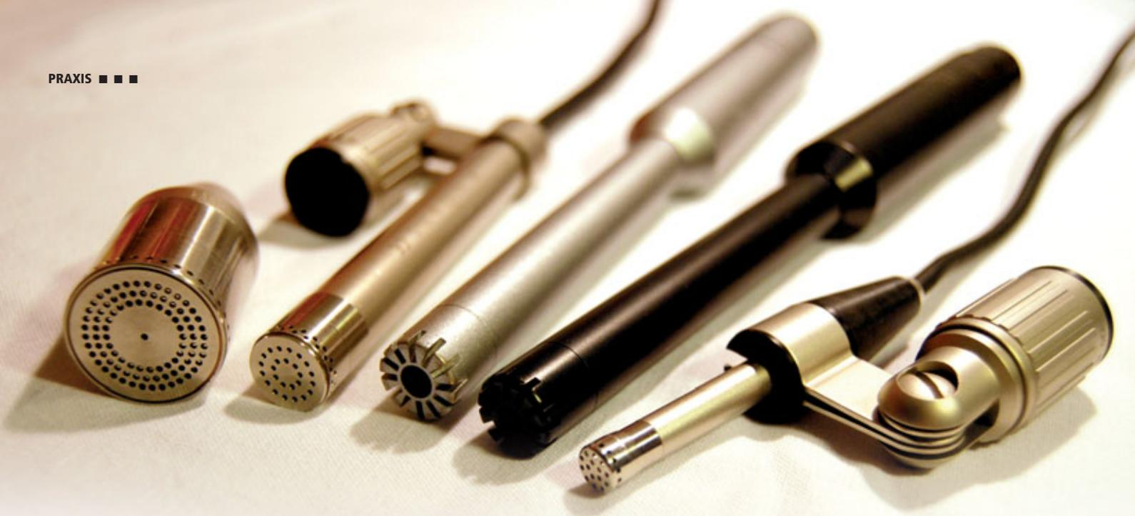
**Abb. 1:** Messmikrofone verschiedener Preisklassen mit unterschiedlichen Einsatzgebieten (von links nach rechts): Microtech Gefell MK-102 (1-Zoll-Kapsel für niedrige Pegel), MK-201 (1/2-Zoll-Kapsel als solider Allrounder), Behringer ECM-8000 und Haun MBNM 550el (jeweils 1/4-Elektretkapsel, daher mit Phantomspeisung zu betreiben) und Microtech Gefell MK-301 (1/4-Zoll-Kapsel für hohe Pegel)
