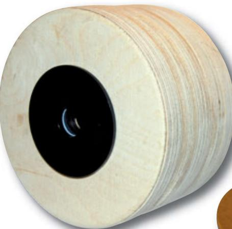
**Abb. 3:** Druckkammer von vorne – dank austauschbarer Adapter können Mikrofone mit unterschiedlichen Durchmessern unter denselben Bedingungen gemessen werden
