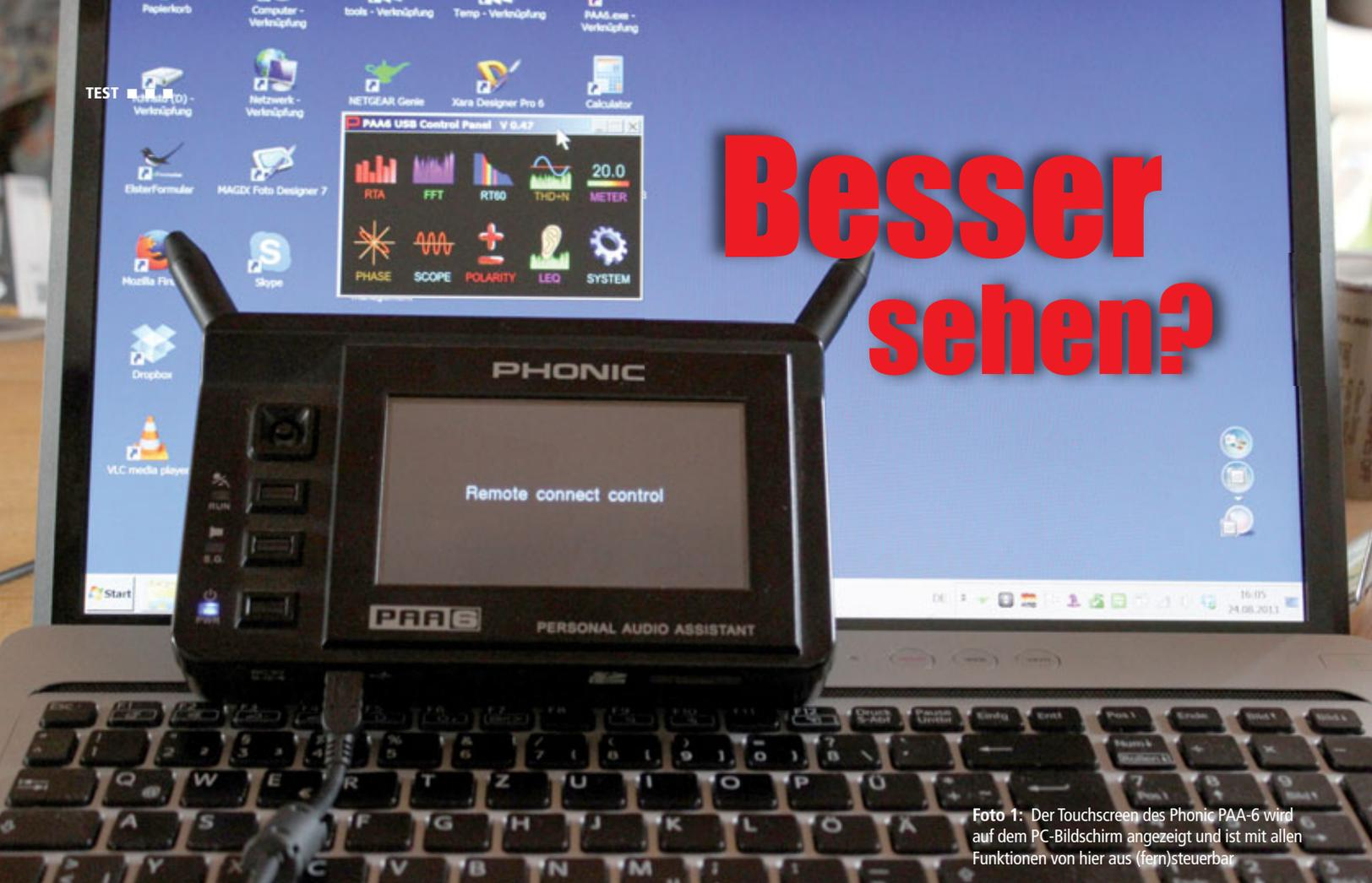
Foto 1: Der Touchscreen des Phonic PAA-6 wird auf dem PC-Bildschirm angezeigt und ist mit allen Funktionen von hier aus (fern)steuerbar
