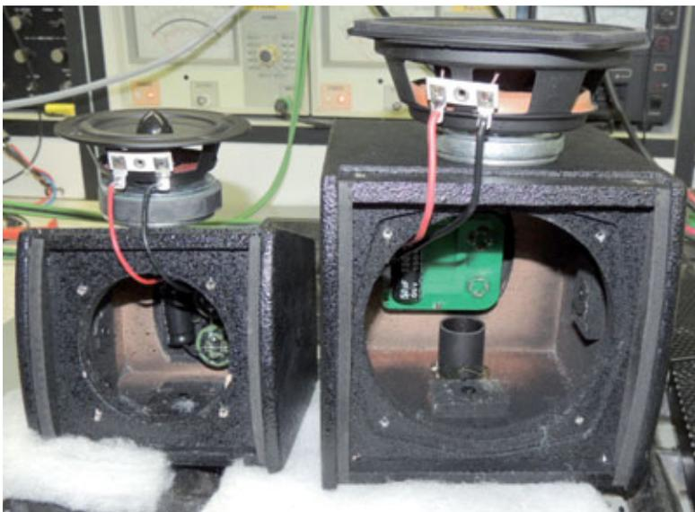
**Bild 1:** Die Lautsprecher der PAB-303 links im Bild und PAB-305 rechts im Bild im Detail – deutlich sind die Verstärkungen an den Gewindebefestigungseinsätzen zu erkennen
