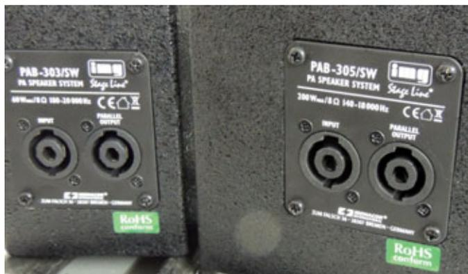
**Bild 6:** Die Lautsprecher bieten Speakon-Anschlussbuchsen – die Anschluss terminals sind durch Ausfräsungen bündig in die Rückwände eingelassen
