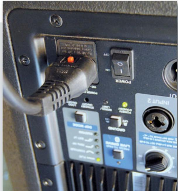
Die beiliegenden Kaltgerätekabel sollten gegen verriegelbare Versionen (erhältlich beispielsweise bei Monacor International) wie in diesem Bild ausgetauscht werden
