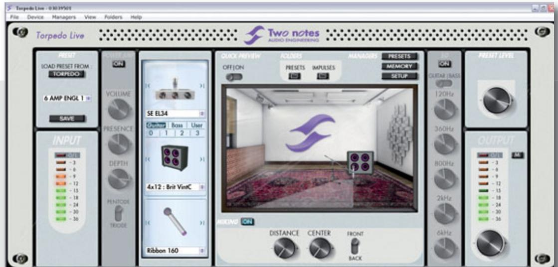
Die „Torpedo“-Remote-Software hilft bei Konfigurierung der Hardware, da das GUI (= Grafik User Interface) alle Parameter-Einstellungen übersichtlich und anschaulich darstellt – die Verwaltung der Presets ist komfortabel per Drag-and-Drop möglich
