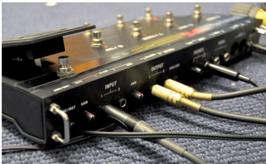
Die „Rig Kontrol3“-Hardware ist nicht nur optimal auf die Steuerung der „Guitar Rig5 Pro“-Software zugeschnitten, sondern gleichzeitig ein USB-2.0-Interface, das Aufnahmen mit bis zu 192 kHz bei 24 Bit ermöglicht
