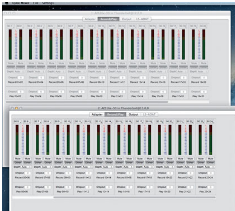
Nur mit der neusten Firmware stehen alle 48 Ein- und Ausgänge via Thunderbolt zur Verfügung
