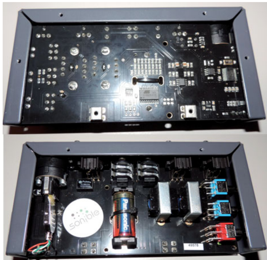
Bild 1: Blick in die sonible ml:1: oben die Lötseite, unten die Bestückungsseite
