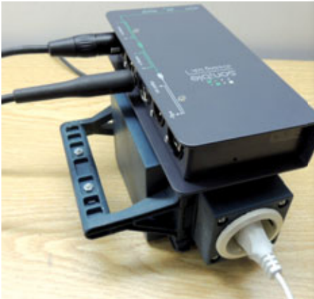
Abb 7: Die sonible ml:1 wird einem Wechselstromstrefeld ausgesetzt; der darunter liegende 230-V-Transformator ist mit einer 50-Watt-Lampe belastet – die entsprechenden Störeinflüsse zeigt Bild 8 >>>
