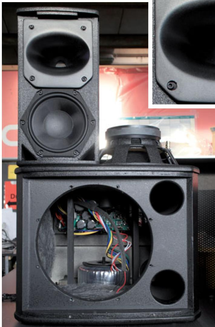
Ein neugieriger Blick ins Innere der Probanden – hinter dem Schutzgitter (mit Akustikschaum) gibt es einen Blick auf die Schallwand der „Move 06“ und in das Innere des PSUB-12 AKA
