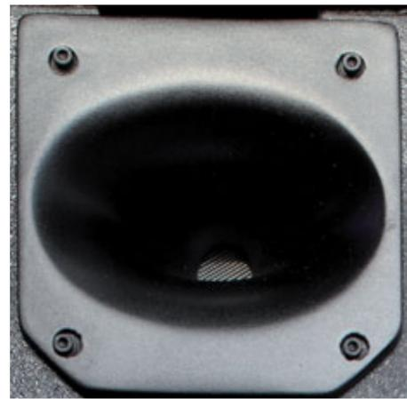
Die Hochtoneinheit der „Move 06“ besteht aus einem drehbaren Horn mit 90 x 60 Grad und einem Beyma Hochtontreiber – vier Schrauben genügen, um das Horn zu drehen
