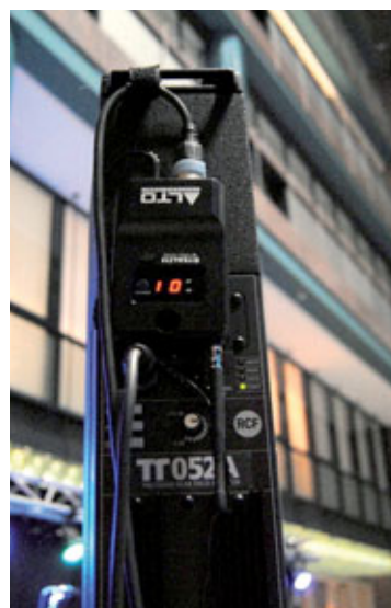
Die „Stealth“-Sender sind sehr leicht, weshalb man sie problemlos mit einem Kabelklett an einer Box arretieren kann
