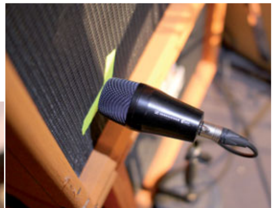
Abb. 5: Tiefton-Abnahme: Am Bass-Amp kommt ein Sennheiser e-902 zum Einsatz
