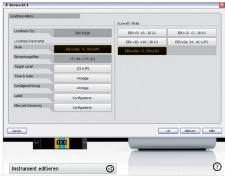
Bis ins Detail lassen sich die Parameter der Instrumente den jeweiligen Ansprüchen entsprechend einstellen – so stehen für die Loudness-Messung beispielsweise unterschiedliche Bewertungsfiter (hier nach ITU BS.1770 (k)) oder Skalentypen zur Verfügung
