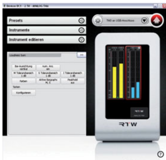
Sollen für die Loudness-Messung nur zwei Bargraphen (M-, und S-Wert) angezeigt werden, lässt sich das problemlos umsetzen; der wichtige I-Wert kann dann beispielsweise numerisch angezeigt werden
