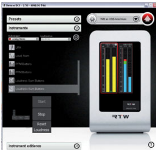
Auf der linken Seite der grafischen Bedienoberfläche (GUI) lassen sich die Instrumente auswählen und per Drag-and-Drop in die Display-Abbildung ziehen und dort individuell anordnen – unterhalb der Instrumentenliste erscheint eine Vorschau des ausgewählten Instruments, in diesem Fall die Loudness Sum Buttons
