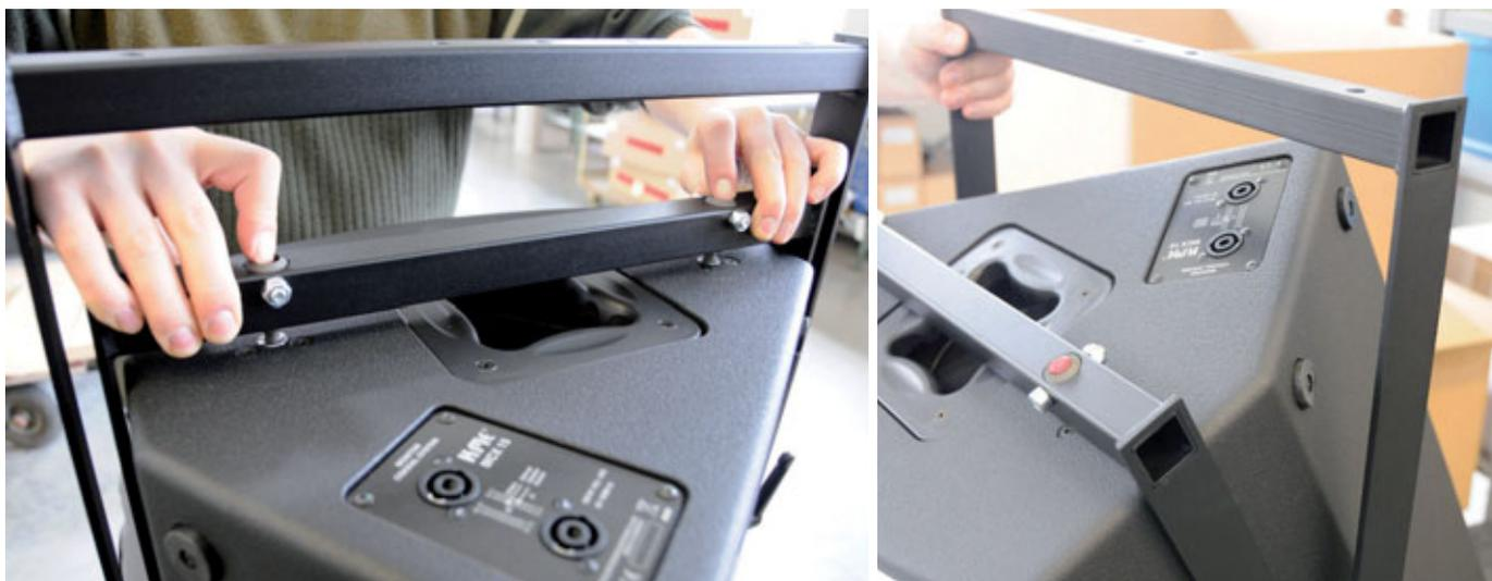
K.M.E. hat an der Oberseite der Box zwei „Variofix“-Befestigungspunkte vorgesehen, in die sich werkzeuglos ein doppel-u-förmiger Flugrahmen über Kugeltragebolzen einrasten lässt
