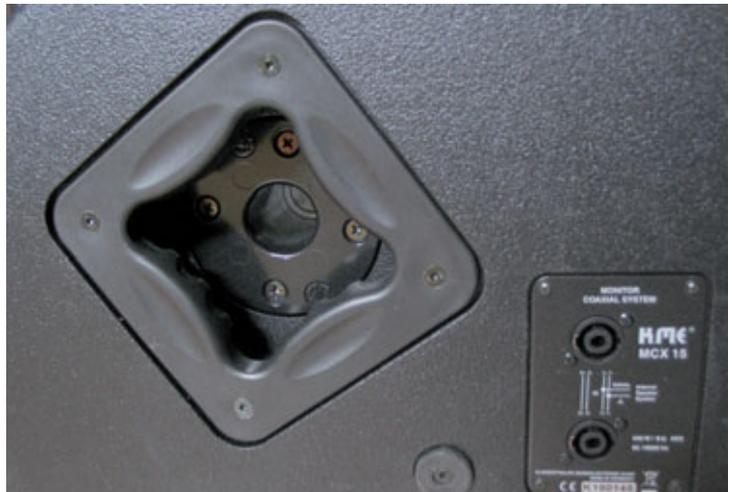
Clevere Detaillösung beim MCX-15: Stativflansch inmitten der Griffmulde
