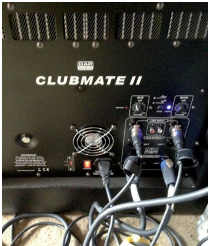
Der 15-Zoll-Subwoofer beheimatet auch die Endstufen des Systems
