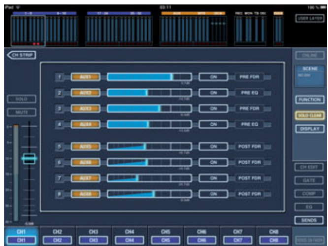
Kanal 1 verzweigt auf die Aux-Wege 1 - 8; das ist Pre-EQ, Pre- oder Post-Fader möglich
