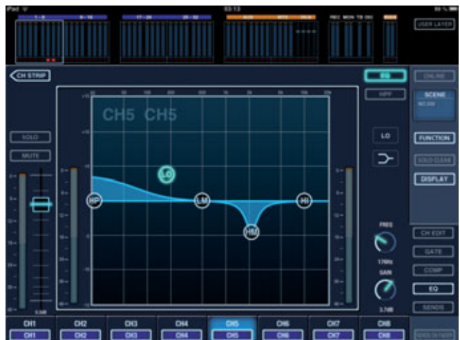
Editierter Kanal-EQ mit vier vollparametrischen Bändern plus HPF – justieren lassen sich die Filterkurven sehr einfach durch Berühren und Verschieben der Filterpunkte
