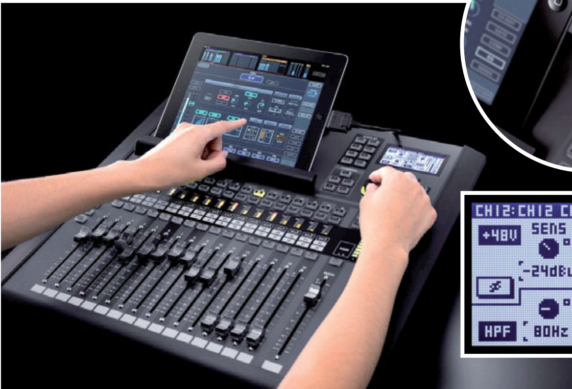
Display mit 132 x 64 Bildpunkten – falls das iPad nicht griffbereit ist
