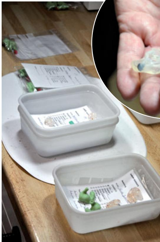
Im Labor von Hearsafe werden aus den Abdrücken die Ohrstecker gefertigt und anschließend mit speziellen Lautsprechern fürs Inear-Monitoring oder lediglich mit Filtern für den maßgeschneiderten Gehörschutz bestückt
