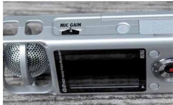
Sehr gut: Aussteuerung der internen Mikrofone per Drehregler
