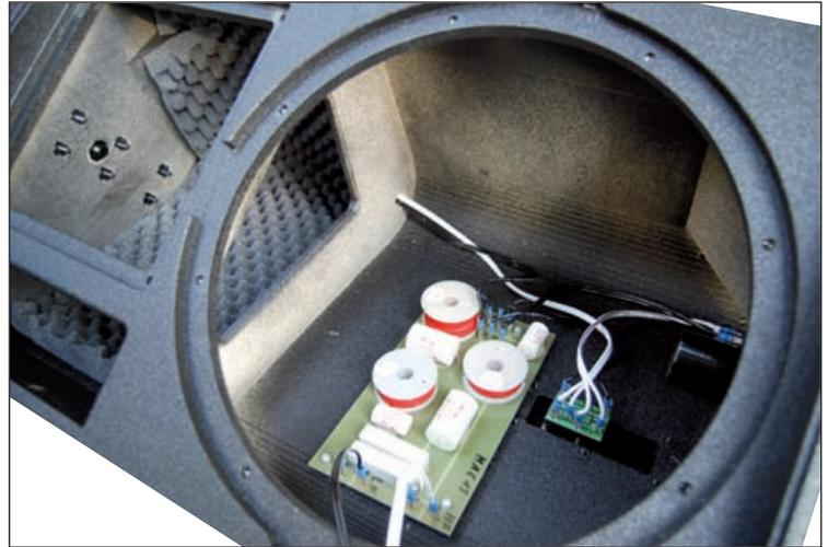
Abb 3: Blick in das geöffnete Gehäuse mit Sicht auf einen umlaufenden Versteifungsgürtel, die passive Frequenzweiche sowie die stellenweise genuteten und mit Kleber verfüllten Seitenwände, die so die Gehäuseform der „Magnus 15“ mit den großen Kantenradien möglich machen (das Dämpfungsmaterial wurde für das Foto teilweise entfernt)
