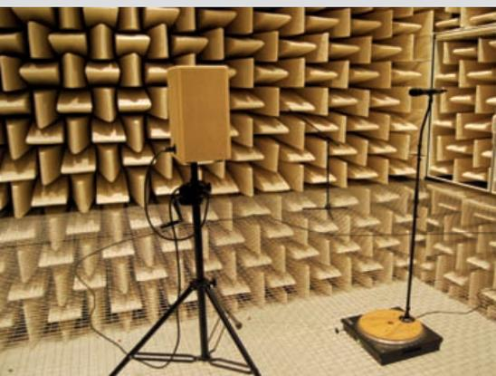
Abb 2: Der ferngesteuerte Drehteller Linear-X LT-360 ermöglicht sehr genaue Messungen des Richtverhaltens der Mikrofone, indem er sie in Winkelschritten von 5 Grad um die eigene Achse rotiert
