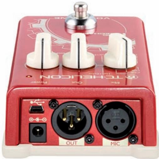
Anschlussfront: Der „Mic Mechanic“ setzt auf symmetrische XLR-Ein- und Ausgänge (Foto: TC Helicon)
