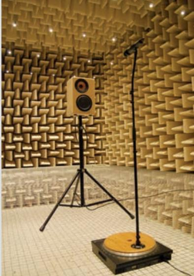
Abb 1: Messaufbau im reflexionsarmen Raum für die Ermittlung des Frequenzgangs in 1 m Entfernung sowie für die Richtcharakteristiken
