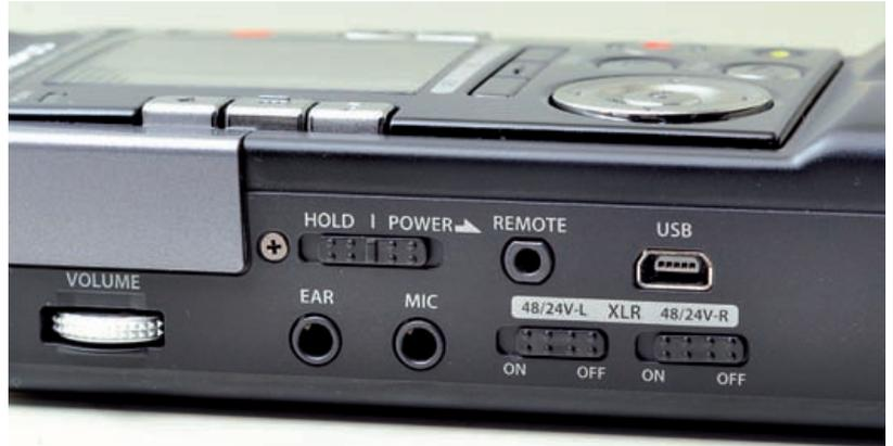
Bei der Menge an Bedienelementen auf engem Raum bleibt der Komfort schon mal auf der Strecke - Lob gibt es für die doppelt schaltbare Phantomspeisung
