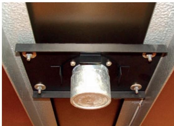
Abb. 3: Der Schallgeber: eine aufgehängte Magnetanordnung, die mit der 4-Watt-Endstufe der EMT angesteuert wird
