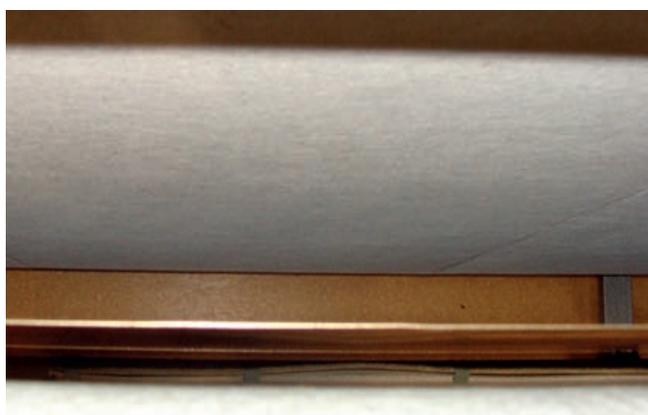
Abb. 5: Die eigentliche Hallplatte, darüber die verschiebbare Dämpfungplatte aus Holzfasern
