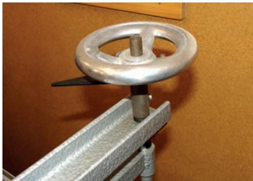
Abb. 6: Dämpfungsrad für die mechanische Regelung der Nachhallzeit
