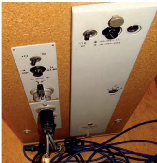
Abb. 8: Steuerelement der EMT-140
