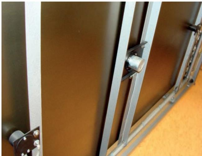
Abb. 2: Links und rechts je ein Tonabnehmer, in der Mitte der Signalgeber, der das Signal auf die Platte bringt
