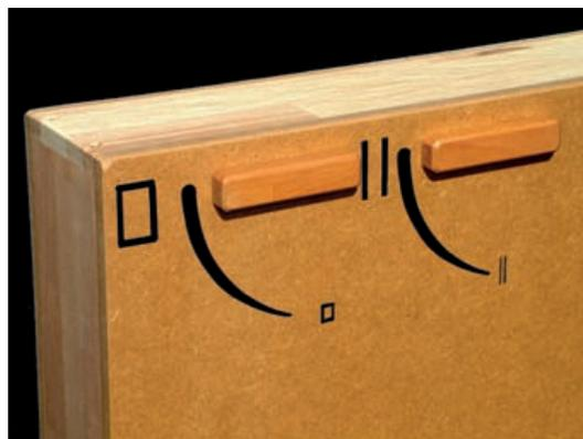
Abb. 14: Mechanische Hebel zur Einstellung der Dämpfung und zur Arretierung der Hallplatte beim Transport (Foto: D. Schöpf)
