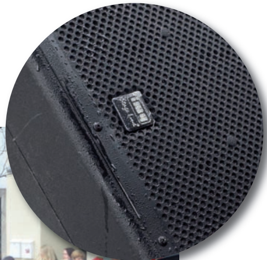
Das Regenwasser perlt am Vlies ab und kommt so nicht bis an die Treiber
