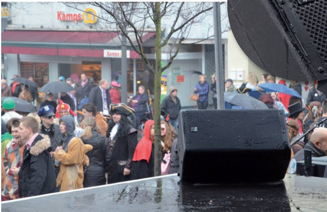
Das Regenwasser perlt am Vlies ab und kommt so nicht bis an die Treiber
