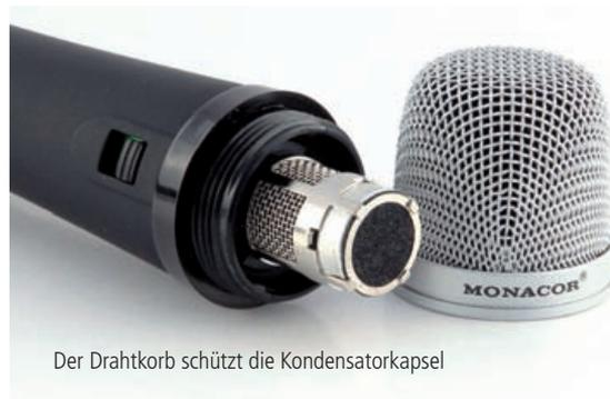
Der Drahtkorb schützt die Kondensatorkapsel
