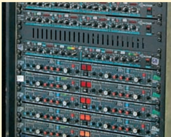
Bild 4: Ein klassisches Liverack mit fünf BSS DPR-402 Kompressoren
