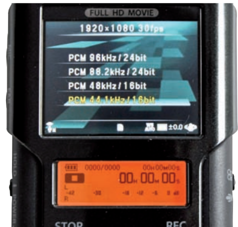
Zwei Displays: Das untere dient der Kontrolle der Audio-Aufnahme, beispielsweise, wenn die qualitativ überzeugenden Mikros ohne die Video-Funktion genutzt werden
