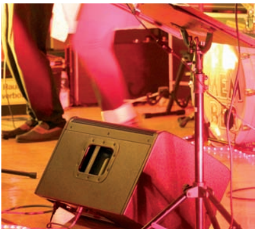
Die ELX-112P ist durch das asymmetrische Gehäuse als Monitor einsetzbar
