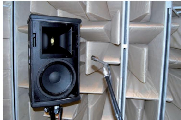
**Abb. 8:** Geräuschmessung in 0,5 m Entfernung zur Boxenfront mit der hochempfindlichen und sehr rauscharmen Messmikrofonkapsel MK-102
