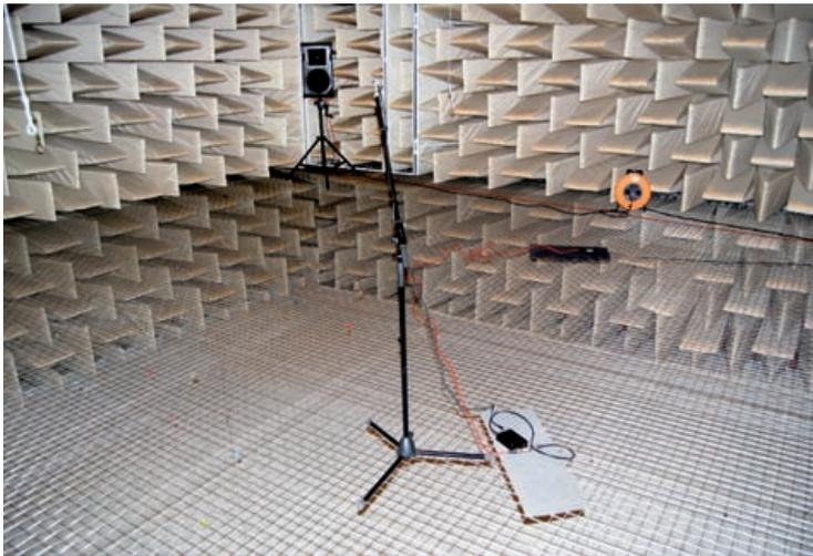
**Abb. 7:** Messaufbau im reflexionsarmen Raum mit Messmikrofon (Microtech Gefell Impedanzwandler MV-203 mit Messmikrofonkapsel MK-201) in vier Metern Entfernung zum Lautsprecher. Die Schaumstoffstücke unter den Steckern dienen weniger der Unterdrückung von Reflexionen, sondern verhindern vielmehr Brummschleifen über das nicht ummantelte Stahlseilnetz, welches im RAR die begehbare Fläche bildet.
