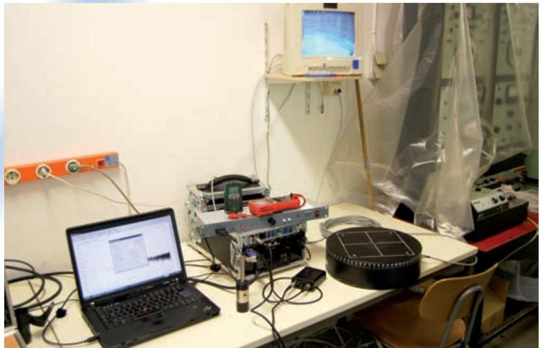
**Abb. 1:** Der Arbeitsplatz im Vorraum des reflexionsarmen Raums (kurz RAR) in der TU Berlin. Neben den versammelten Messgerätschaften des Autors steht auch ein kleiner Monitor zur Verfügung, der mit einer Kamera im Messraum verbunden ist. So lässt sich zum Beispiel erkennen, wenn das Messmikrofon im Stativ nach unten kippt, die Box vom Drehteller fällt oder sonstige „Katastrophen“ eintreten.
