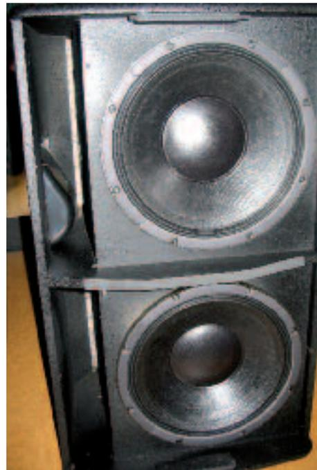
Der PS-212-Subbass mit Doppelzwölfzoll-Bestückung und seitlichem Reflexkanal
