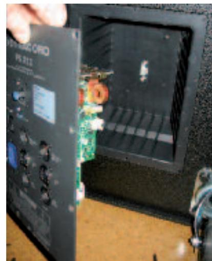
Das Elektronikmodul des PS-212 sitzt rückseitig in einer luftdichten Wanne – in der Mitte befindet sich der Steckkontakt zu den Lautsprechern
