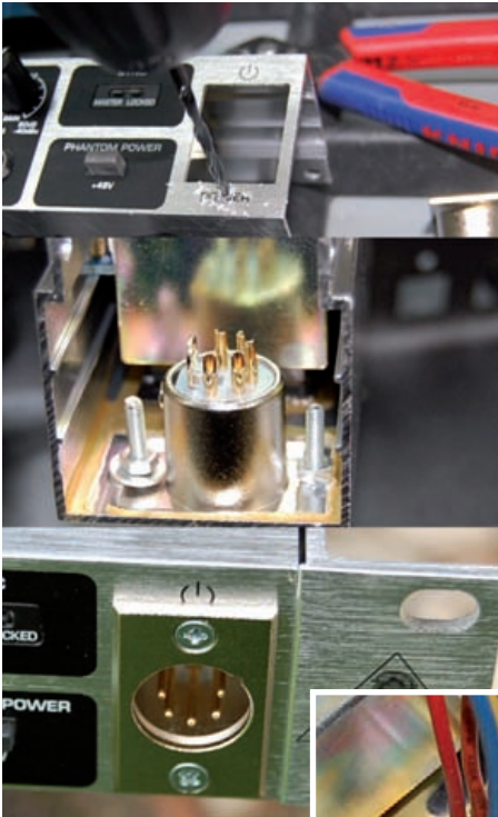
Bild 5: Wo der ehemalige Ein-/Aus-schalter war, wird nun die XLR-Buchse angebracht – hier muss nur ein 4-mm-Loch gebohrt werden
