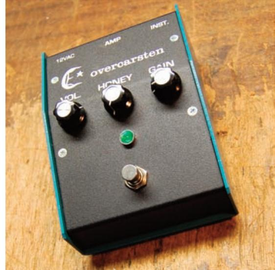
Abb. 9: Eigenproduktion: Der Eckermeister „Overcarsten“ ist ein Verzerrer, der den Klang einer übersteuerten Verstärkerendstufe simuliert
