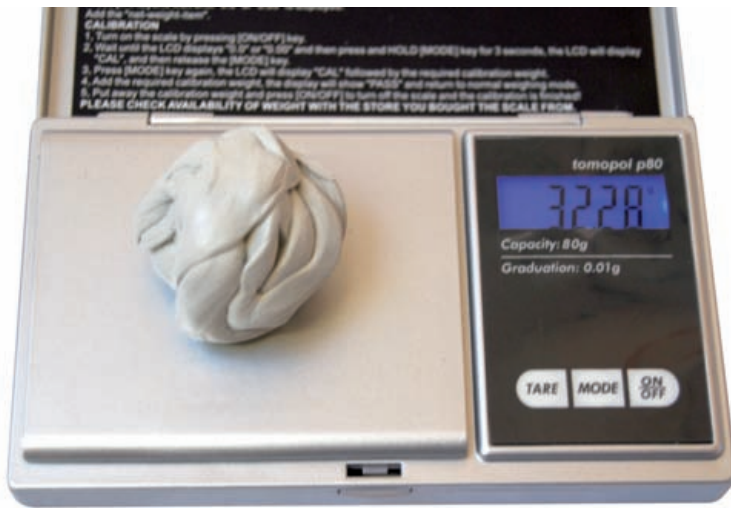
Abb. 3: Testmasse zur Ermittlung der Thiele-Small-Parameter, die möglichst genau bekannt sein müssen (Messung mit einer Feinwaage)
