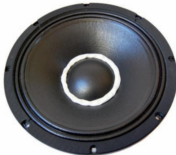
Abb. 4: Die selbsthaftende Testmasse wird symmetrisch auf dem Chassis angebracht
