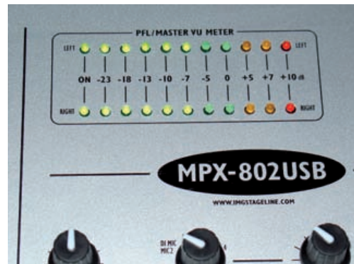
Gut sichtbare LED-Anzeige für den Master-Out
