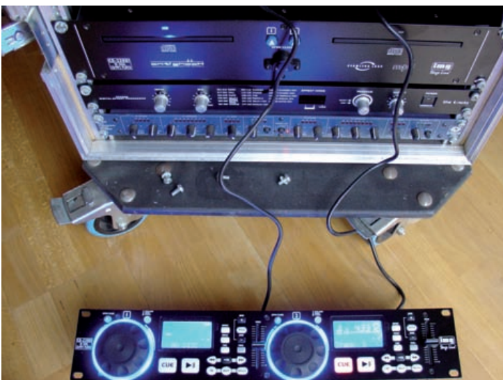
Bedienteil und Laufwerke lassen sich beim CD-230 DJ trennen
