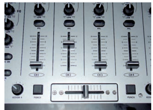
Crossfader mit zuweisbaren Eingangssignalen und Punch-Taster
