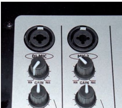
Zwei XLR-Inputs zum Anschluss dynamischer Mikrofone (Phantomspannung ist nicht vorgesehen)
