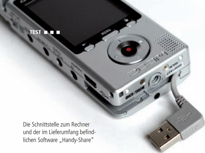
Die Schnittstelle zum Rechner und der im Lieferumfang befindlichen Software „Handy-Share“
