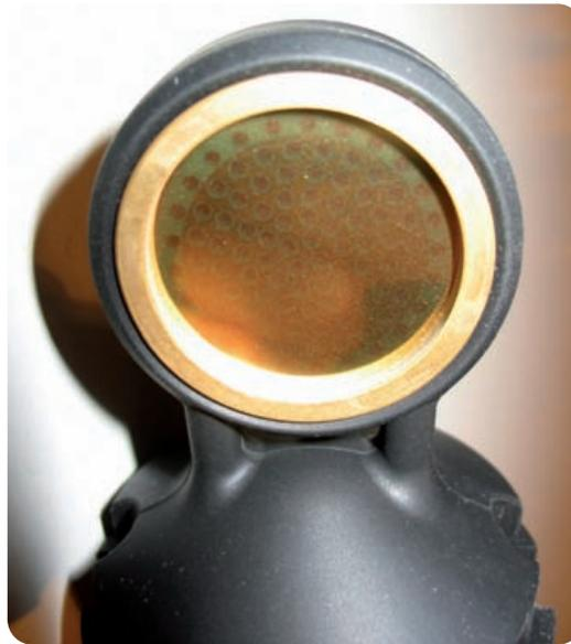
Alles Gold – die mit 24karätigem Gold beschichtete 1-Zoll-Membran ist samt Rahmen schwingfähig in einen Ring aus Gummi eingefasst
