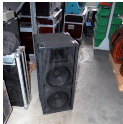
Abb. 9: ...und als 2 x 12-Zoll + CD-Horn mit Gitterfront (S-4BR)
