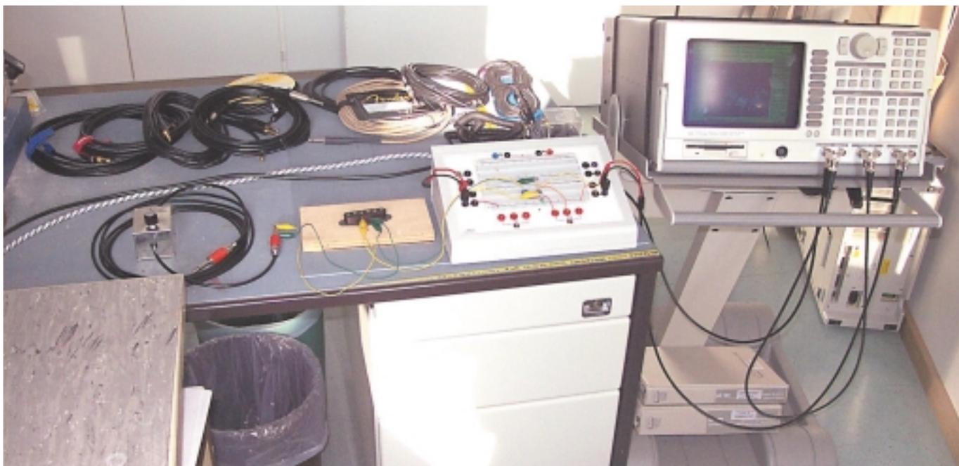
Gruppenfoto: Alle »Testkandidaten«, der speziell für diesen Test konstruierte, stufenlose »Dreh-Kondensator«, der als Referenz genutzte Singlecoil-Pickup sowie die beteiligte Messtechnik
