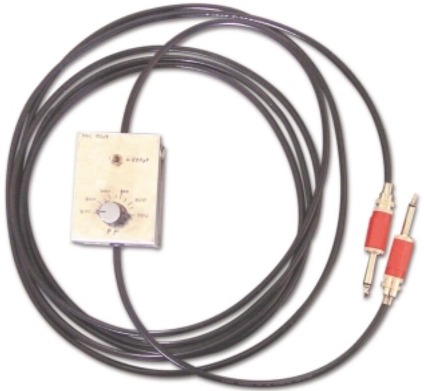
Foto 4: Eine ganz wichtige Variable für den »Kabelklang«: Die Kapazität, angegeben in Picofarad - mit Hilfe des hier abgebildeten, stufenlos einstellbaren »Dreh-Kondensators«, ließ sich nahezu jede Kapazität und die damit verbundene Beeinflussung auf den Klang simulieren
