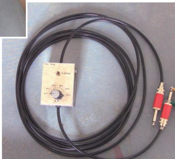
Foto 3: Eine wichtige Variable für den „Kabelklang“: Die Kapazität, angegeben in Picofarad – mit Hilfe des hier abgebildeten, stufenlos einstellbaren „Drehkondensators“ ließ sich nahezu jede Kapazität und die damit verbundene Beeinflussung auf den Klang simulieren
