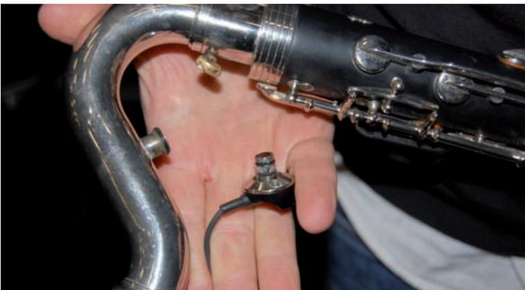
Abb. 6: Sonderanfertigung für spezielle Bedürfnisse – in die Bassklarinetten eingelassenes Tonabnehmermikrofon von Rumberger Sound Products
