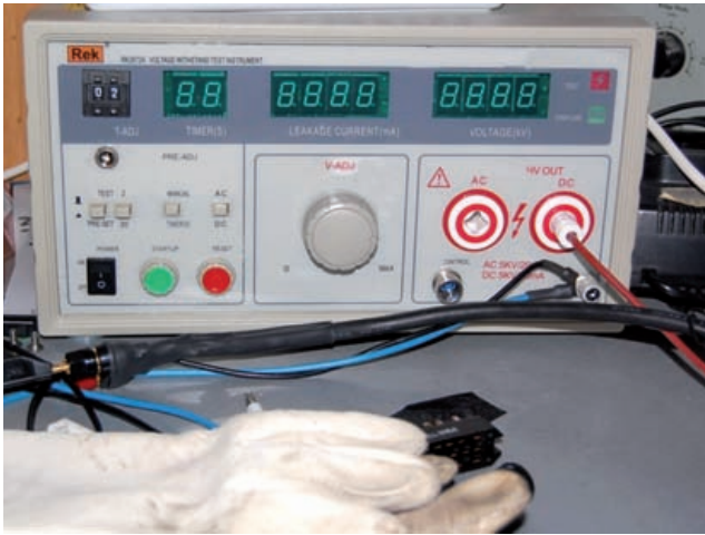
Abb. 3: Ein Isolationstester für 5.000 Volt Gleich- und Wechselspannung
