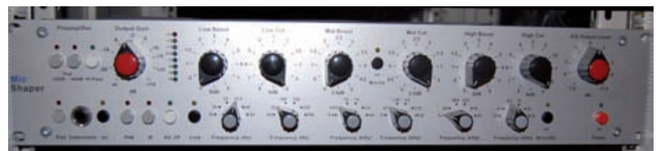
Abb. 7: Der „MicShaper“ ist ein sehr interessanter Equalizer, dessen Funktionsumfang auf die 3-HE-Einschubkarte in Bild 8 komprimiert werden konnte.
