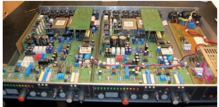
Abb. 6: Der PMV-707 mit geöffnetem Deckel zeigt, wie aufwendig eine Zweikanal-Vorstufe sein kann
