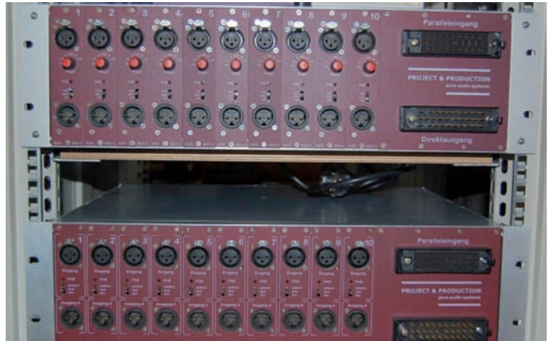
Abb. 4: Der Rundfunksplitter ASS-933 wird von Oztzronics für Project & Produktion gebaut
