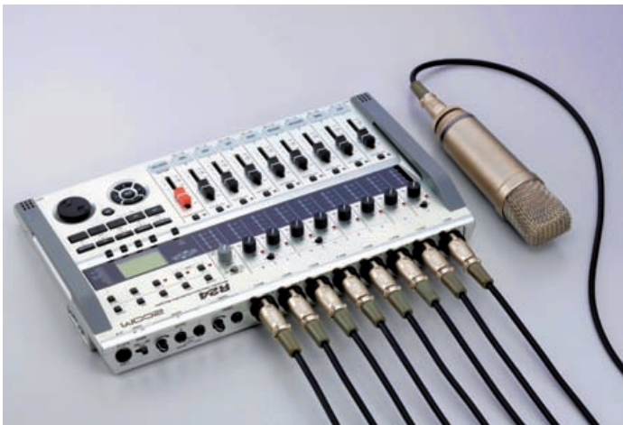
Acht Mikrofoneingänge und schaltbare Phantomspeisung
