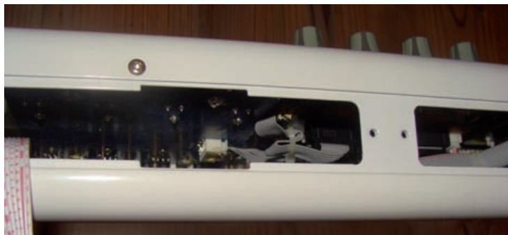
Die interne Verkabelung erweist sich beim Einbau als hinderlich
