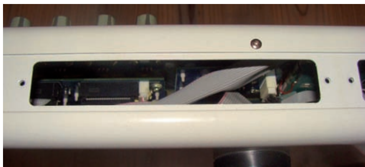
Die interne Verkabelung des mittleren Slots verhindert jeglichen Einbauversuch
