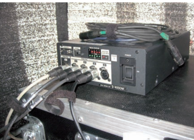
Der S-4000 M Merger kombiniert bis zu vier Roland Digitalcores auf einen REAC-Eingang
