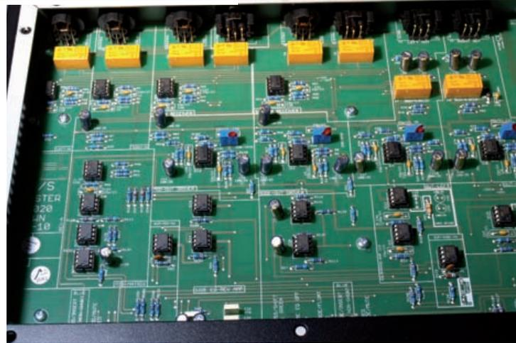
Bild 4: Übersichtlicher Aufbau und Relais zum Umschalten
