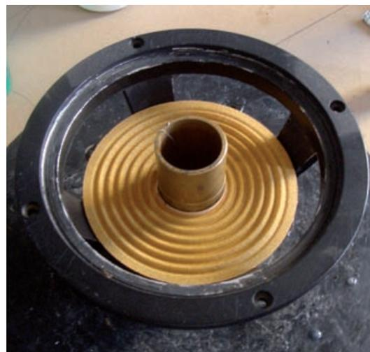
Abb. 14: Speaker-Aufbau: Erst wird der Zentrierdorn mit der Schwing-spule auf den Polkern aufgebracht, dann die Zentrierung eingeklebt...
