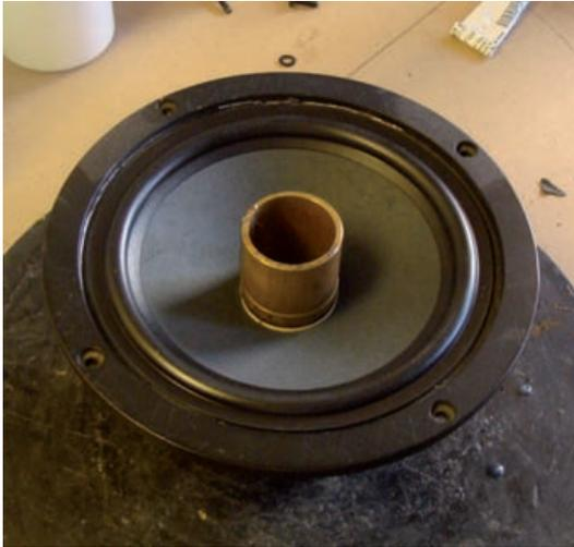
Abb. 15: .... anschließend wird die Membrane aufgelegt und mit der Zentrierung, der Schwingspule und dem Korb verklebt
