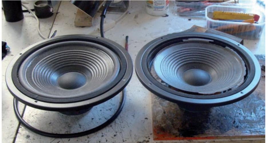
Abb. 16: „Refoamen“ eines Speakers: Links die funktionsfähige Variante, rechts die defekte – die alte Schaumwicke wird entfernt und die neue eingeklebt
