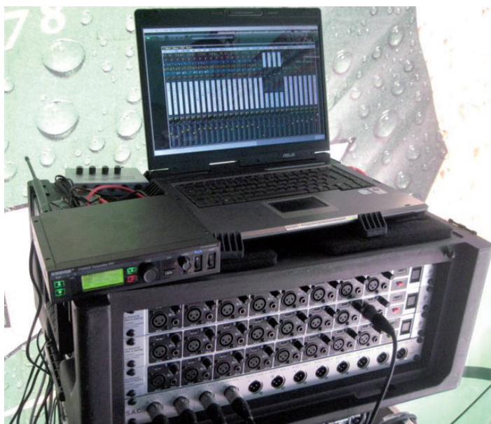
Das PSM-900 als Nobellösung zum Abhören von Solo/PFL-Signalen für das virtuelle SAC Mischpult
