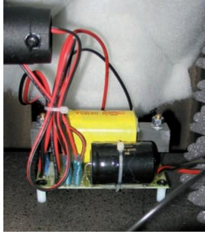
Die Frequenzweiche im Inneren, links der „E-Connect“-Flansch
