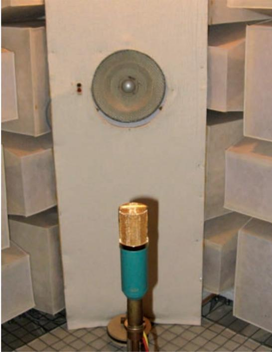
Abb. 7: Wie alle anderen Kandidaten musste auch das V-67 Q von MXL eine ausgiebige Sinus-Tortur im reflexionsarmen Messraum der Firma Neumann in Berlin über sich ergehen lassen
